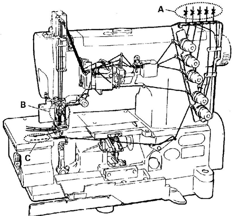
4. 穿线图 Threading diagram
