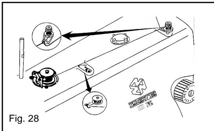
O enchedor de bobina e o tensor do enchedor de bobina estão ilustrados na figura 28.
